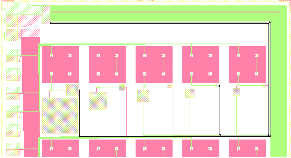
图 3.2 一个电容分压式微纳 LC 振荡器阵列的部分图纸。
